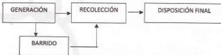
Figura 6. Flujograma de un sistema simple de manejo integral de los residuos sólidos urbanos.
